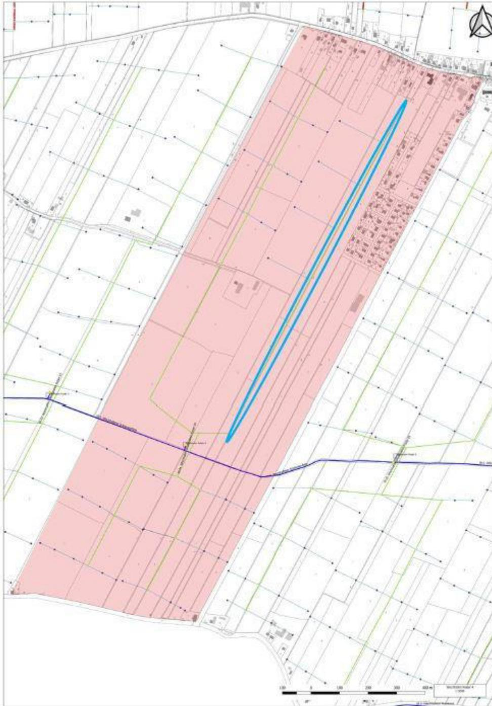
**Abbildung 8:** Öffnung eines Grabens (blau umrandet) u.a. für die Regenwasserrückhaltung als Ersatz für die Polder-Rohrleitung (grün) im Polder 4 des Entwässerungsverbandes Nordkehdingen. Der Einzugsbereich des Polder 4 ist flächig rosa dargestellt.
